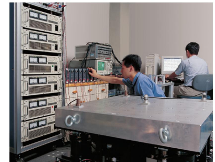
除振装置に求められる、優れた定盤の条件。それは、まず高剛性であること。同時に高ダンピング特性を持つこと。そしてできるだけ軽量でありたい。この条件を満足するため、明立精機のスチールハニカム定盤は着実に進歩します。
