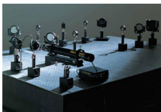
AYAシリーズ、それは明立精機が独自に開発した先進テクノロジーの集大成。特に、水平方向の除振性能を強化することによって、垂直・水平の全方向の微妙な振動も嫌う、干渉計やホログラフィーをはじめとする光学実験ニーズに応えました。さらに、各種機構の性能も一段と向上。スチールハニカム定盤の特長をプラスした高性能な除振装置です。
