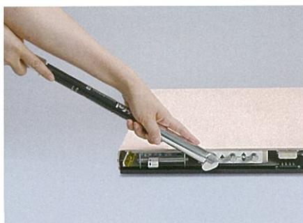
設置場所の気温変化によって搭載盤が上下します。使用開始前に浮上の具合を点検してください。
