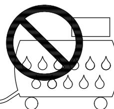
供給エアに水分が含まれている場合、フィルター付レギュレータに水が溜るので、定期的（2週間に1回程度）にフィルターの下のバルブを押して水を抜いてください。
