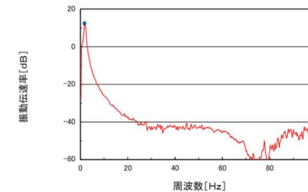
振動伝達率 (AY-2015K4 水平方向、搭載質量300kg)
