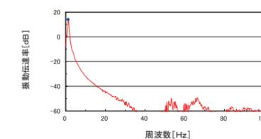
振動伝達率 (AYA-2415K4 水平方向、搭載質量300kg)
