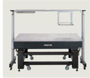
電源タップ(2P1E×4、最大1500W)が付属、前面もしくは背面に取付可能。スライド式棚(搭載可能質量30kg)もオプションで取付可能です。
